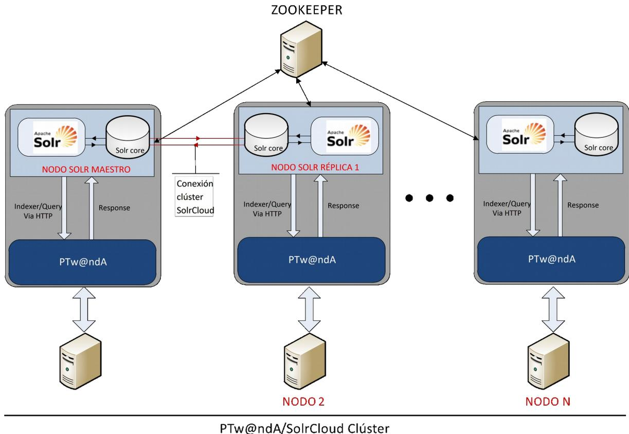
La configuración expuesta en la imagen anterior consta de un nodo zookeeper, encargado de coordinar los nodos de SolrCloud así como mantener los ficheros de configuración de Solr.
